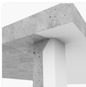
Betonflachdecken und Betonstützen
